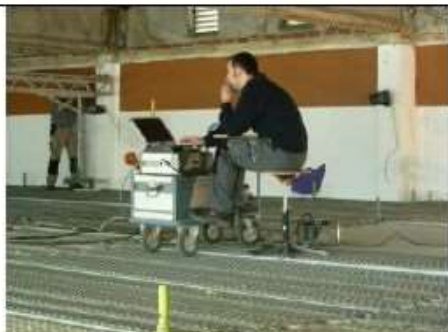
Steuergaräte für die Magnetisierung und das Vermessen des Magnetfelds sowie PC zur Datenerfassung und -auswertung
